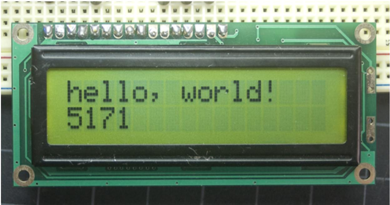
Fig. 1.1: Lcd display 1602
